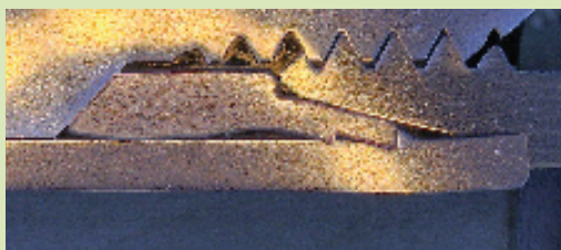
6: Korrekter Einschnitt des Schneidrings in das Rohr
