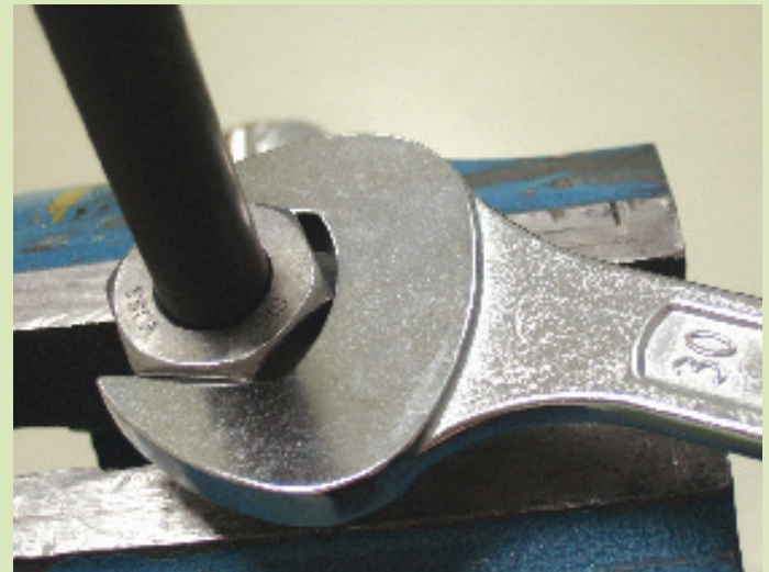
2: Beschädigen der Korrosionsschutzschicht durch Endmontagevorgang
